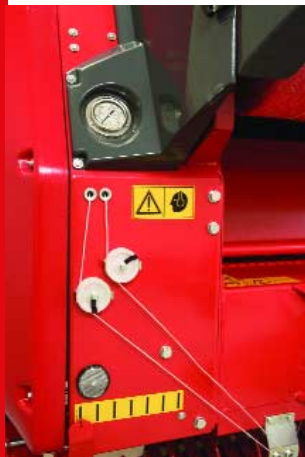
Legatore doppio spago con indicatore esterno di posizione Double twine binder with outside indication of position Liège double ficelle avec indicateur extérieur de position Atador doble hilo con indicador exterior de posición
